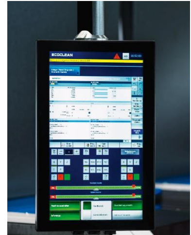
新型 EcoCvelox 将去毛刺和清洗与高速自动化相结合，使这些过程可以在一台机器上一站式高效地进行。在新的直观操作面板的 19 英寸纯平屏幕（HMI）上，机器的每个模块均以完整概览的形式清晰地分别显示，类似于智能手机的显示屏。
